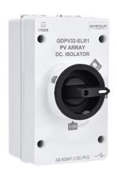
Der DC-Trennschalter der Serie GDELR1 wird in privaten oder gewerblichen Photovoltaikanlagen mit einer Leistung von 1-20 kW eingesetzt und zwischen den Photovoltaikmodulen und den Wechselrichtern platziert. Die Lichtbogenzeit beträgt weniger als 8 ms, die maximale Spannung beträgt bis zu 1200C DC.
