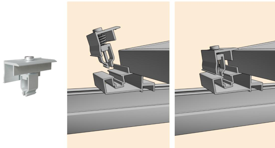
9) Zum Schluss setzen Sie die Mittelklemmen in den Schlitz der hinteren Stütze und ziehen die Schraube fest.
