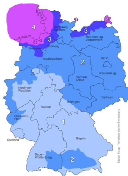
Für die Windzonen 1 und 2 sollten sie mit 20 kg Gewichten planen (2 pro Ballastplatte). Bei höheren Windzonen sollte das Gewicht über 20 kg wiegen.
