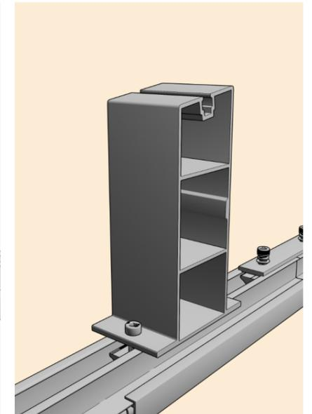
4) Schieben Sie anschließend den vorderen Standfuß durch die Schiene an die richtige Position und befestigen anschließend die M8\*25 Schraube. Wiederholen Sie den Schritt mit allen Standfüßen vorne.
