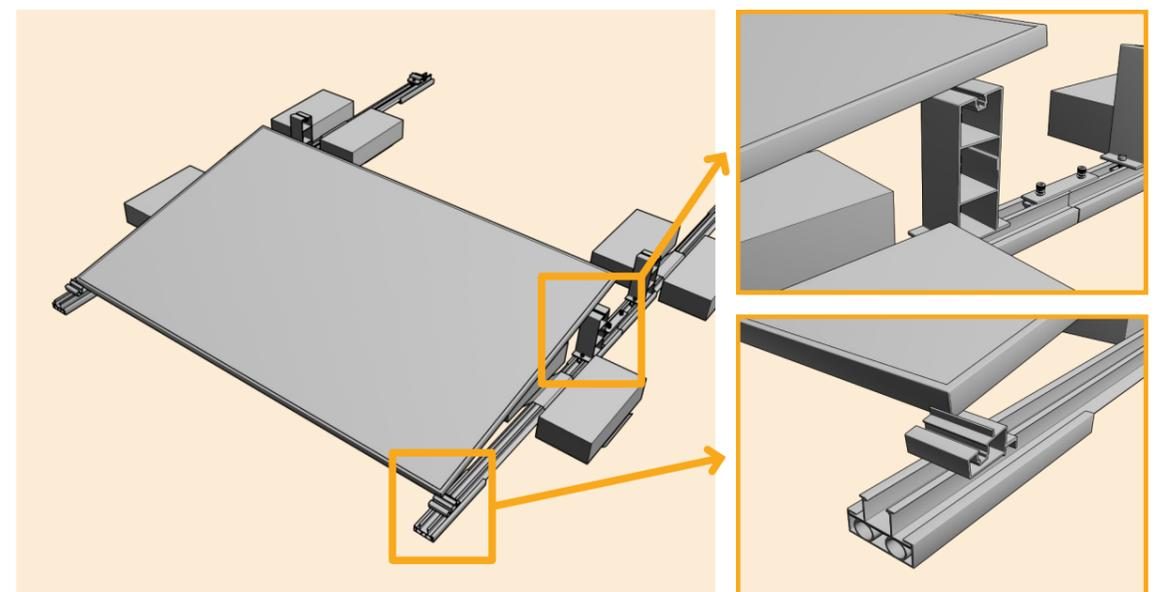
7) Setzen Sie die Endklemme wie gezeigt in den Schlitz der vorderen Stütze ein und ziehen die Schraube fest. Wiederholen Sie den Schritt für alle vorderen Stützen.
