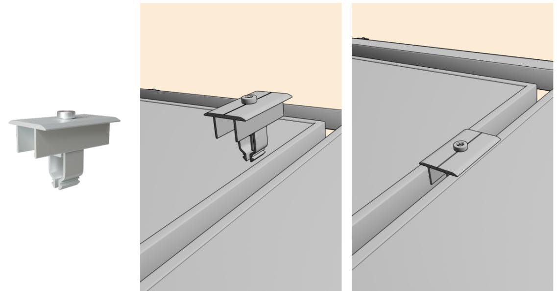
8) Für die hintere Stütze müssen Sie das untere Teil der Klemme um 90° drehen. Danach können Sie diese an der hinteren Stütze anbringen und befestigen.
