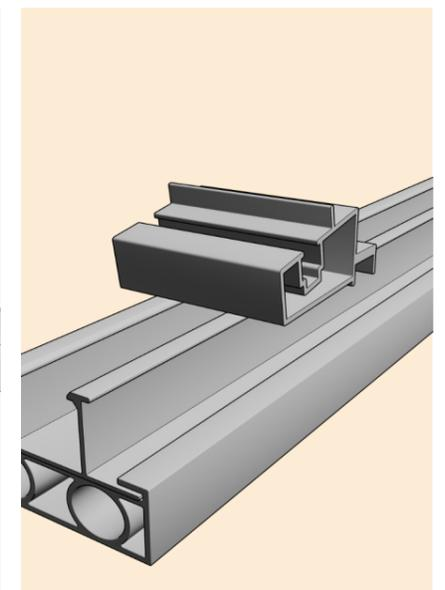
5) So sollte Ihre Konstruktion nun Aussehen. Stellen Sie sicher, dass die Schienen auf einer Höhe liegen. Legen Sie die Ballastplatten auf die Schienen und befestigen diese mit Betonblöcken oder Sandsäcken.
